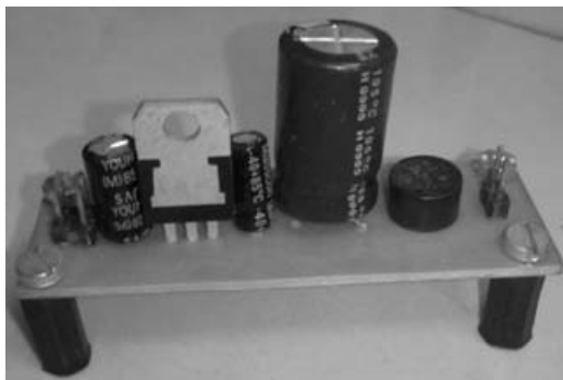
Fig. 4 : Power Supply Module
